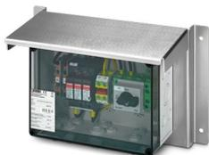
Wetterschutzdach zum Schutz des Generatoranschlusskastens (GAK) vor Umwelteinflüssen bei Montage im Außenbereich, aus Edelstahl, mit rückseitigem M8-Erdungsbolzen, inkl. Befestigungsmaterial für GAK und Erdungsleitung.
