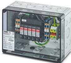
Generatoranschlusskasten für Photovoltaikanlagen bis 1000 V DC zum Anschluss von 2x 1 String. Mit Überspannungsschutz (Typ 2) und Kabelverschraubungen für die Eingangs- und Ausgangsseite.
