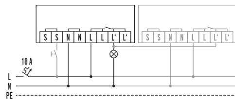
Standardbetrieb mit optionaler Ansteuerung durch Schließtaster und Parallelschaltung von max. 10 Geräten
