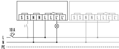
Standardbetrieb mit optionaler Ansteuerung durch Schlieftaster und Parallelschaltung von max. 10 Geräten
