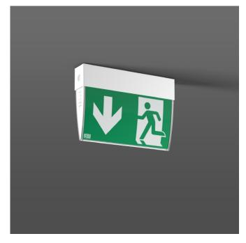
Einzelbatterie-Sicherheitsleuchten zur Rettungswegkennzeichnung Gehäuse Kunststoff (Polycarbonat), schlagzäh. 4 Rettungszeichenfolien und 1 weiße Folie zum Einlegen in die transparente Abdeckung beigelegt. Befestigungswinkel zur Wandmontage und zwei Dichtschrauben beigepackt. Einzelbatteriesystem mit automatischem Selbsttest.
