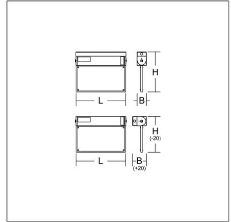
Leuchte zur Rettungswegkennzeichnung. Gehäuse Aluminium-Strangpressprofil pulverbeschichtet. 4 Rettungszeichenfolien und 1 weiße Folie inklusive Befestigungs-Pins zum Aufstecken beigelegt. Universal Befestigungssatz für Decken- und Wandanbau. Betriebsgeräte integriert. Einzelbatteriesystem mit automatischem Selbsttest und Rückmeldung über DALI-Bus ausschließlich an das RZB DALI-Überwachungssystem.
