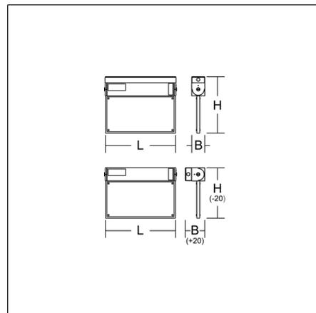
Leuchte zur Rettungswegkennzeichnung. Gehäuse Aluminium-Strangpressprofil pulverbeschichtet. 4 Rettungszeichenfolien und 1 weiße Folie inklusive Befestigungs-Pins zum Aufstecken beigelegt. Universal Befestigungssatz für Decken- und Wandanbau. Betriebsgeräte integriert. Einzelbatteriesystem mit automatischem Selbsttest. Mit Programmierschnittstelle NFC.
